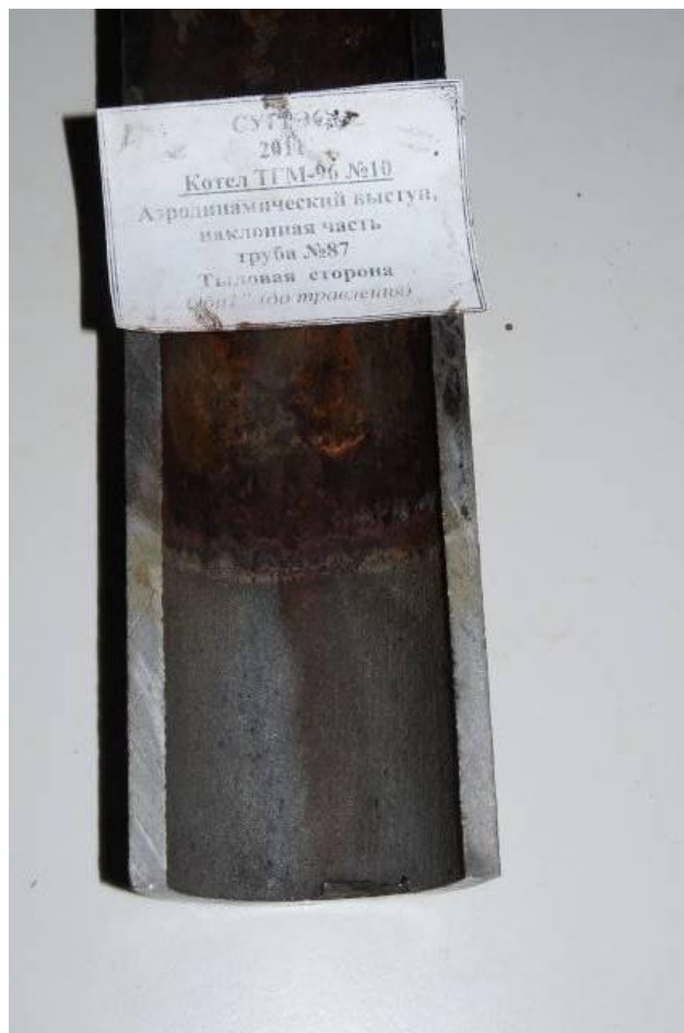
Рис.2 Труба №87 после пребывания в концентрированном средстве «Антиржавин».
