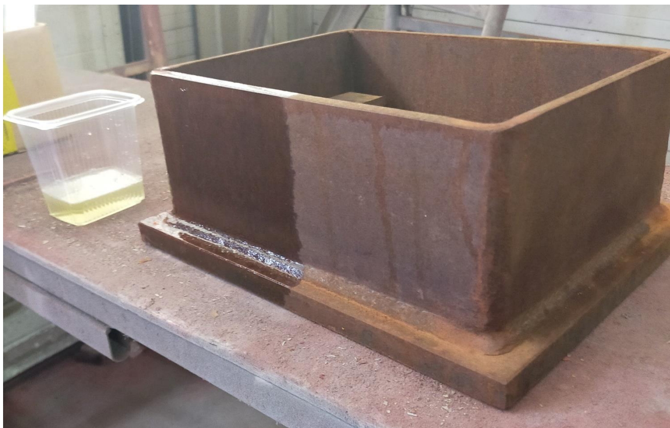
Фото 1. Деталь сразу после обработки реагентом (1-2 минуты).
