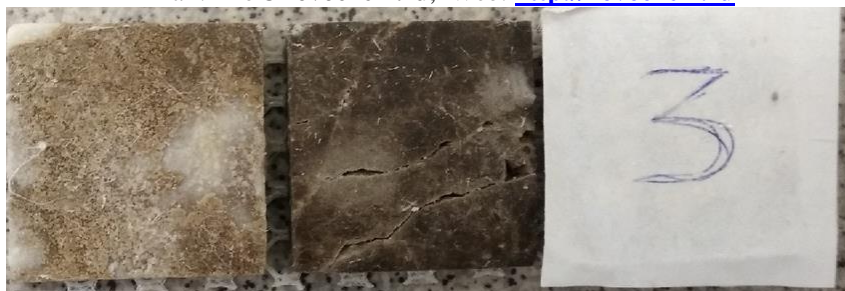
Рисунок 3. Внешний вид образцов после проведения эксперимента со средством «SmartClean-N для хромированных поверхностей»
